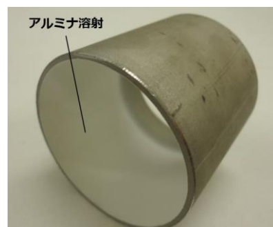
内径施工 (φ 60)
