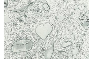
複合材料ステライト#21 クロムカーバイド倍率×160
