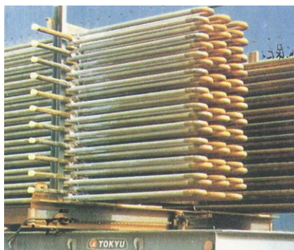
ボイラチューブ
