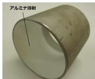
内径施工 (φ 60)
