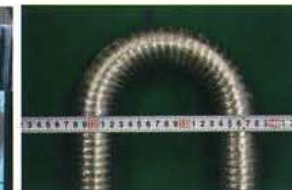
素管寸法:φ48.6×5t(STB410) インコネル肉盛後:φ53.6×7.5t(肉盛層:2.5t) 曲げR:80R
