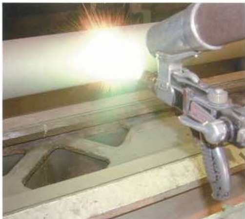
ボイラーチューブ Self-fusing alloy spraying for a boiler tube
