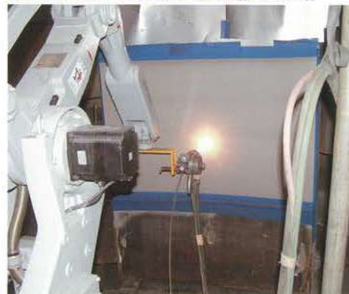
ロボットによるワイヤ溶射 Wire spraying by the robot
