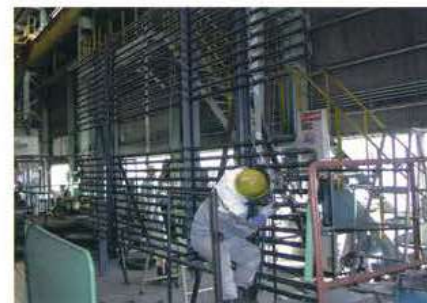
廃熱ボイラー 節炭器製作状況
