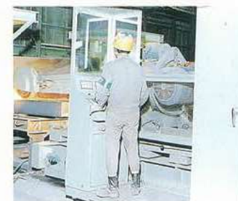
スラブ研削作業
