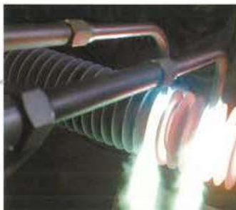
ボイラーチューブ Self-fusing alloy spraying for a boiler tube
