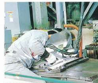
特殊鋼帯鋼の溶接作業
