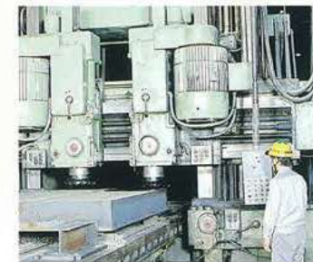
プラノミラーによるスラブ研削作業
