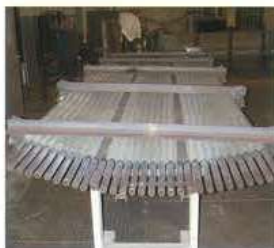
OGフード 水冷パネル Water-cooled panel for the OG hood
