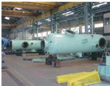
二種圧力容器製作 Manufacturing a pressure vessel
