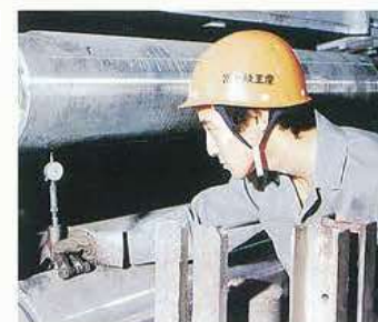
連続鑄造ガイドロールの測定
