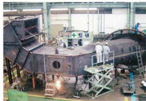
転炉ガス回収装置 輻射部 oxygen converter gas recovery system -radiation part-
