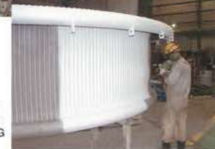
OGフード アルミ溶射施工 Aluminum wire spraying for OG hood
