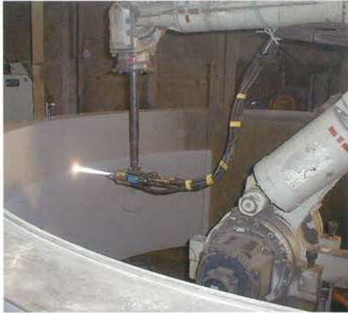
ロボットによるHVOF溶射施工 HVOF spraying using the robot
